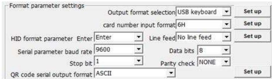
【output format selection】USB Virtual keyboard、USB virtual serial port、HTTP、MQTT、RS232、WG26、WG34、RS485、access control system output( not enabled)、TCP、UDP functions
